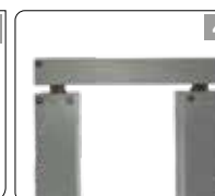
4. Per un miglior contatto mettere del grasso conduttore tra le superfici del nucleo. Fare combaciare le due facce del nucleo avvitando in modo uniforme e distribuito le quattro viti MA. For a better contact put a conducting grease between the surfaces of the core. Be sure to match the two faces of the core, uniformly tighten the four M4 screws.
