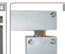
5. Controllare che non ci sia luce tra le due facce del nucleo. Check that there is no room between the two sides of the core.
